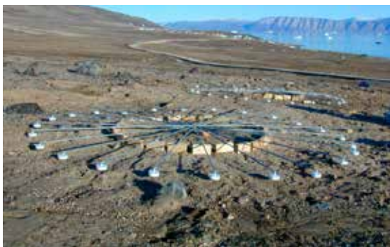
◀ Meetinstrument IS18 is het IMS infrageluid array op Groenland. Bron: CTBTO Public Information
