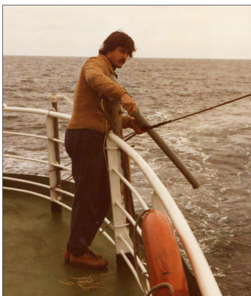
Henk Kalle lanceert een xbt (expendable bathythermograph)
