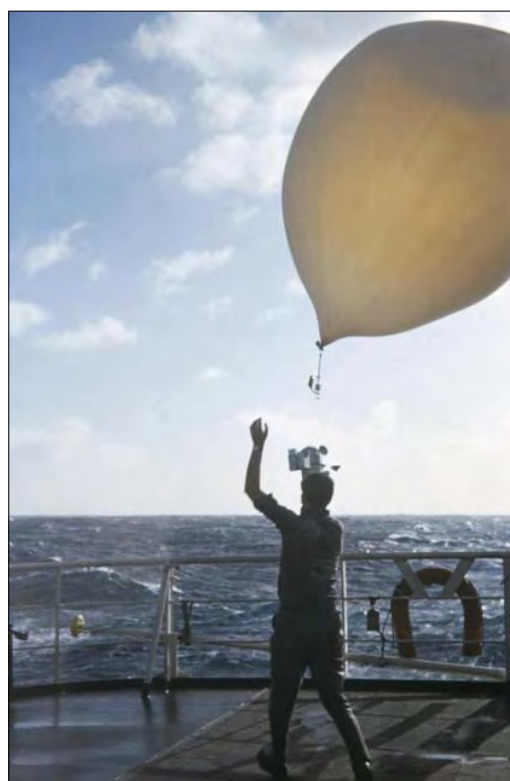
Lancering van de Radiosonde
