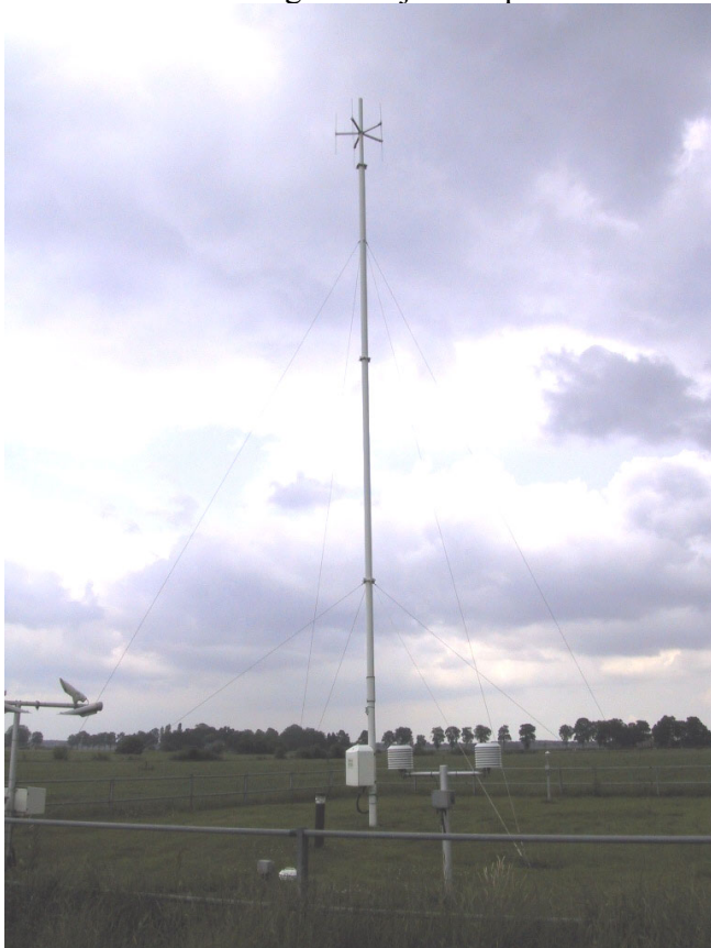
Figuur 2-3 Mast met 5 dipool antennes (in de top)
