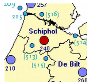
Figuur 2, overzicht van de posities van zichtmeters op land ([a]; situatie 2005) en op zee ([b]; gepland en gerealiseerd); voorzien is de plaatsing van zichtmeters op de stations Westdorpe, Wilhelmina- dorp en Herwijnen. Aangeduid zijn de lokale meetnetten "Mist- posten Schiphol, Mistmeetnet van het GhR en het "Mistmeet Zeeland", zie [c], BTP, [d] RNW en [e] ZLD.
