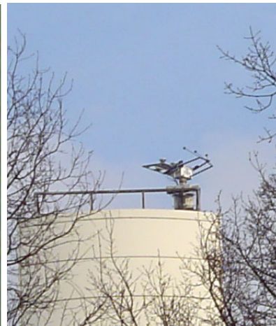
Figuur 4, met behulp van een "globale stralingsmeter" (Kipp CM 11, foto links) wordt de totale inkomende straling gemeten (in de Bilt, 06-26-0, op het dak van gebouw B, alwaar geen hinder is van omliggende gebouwen en bomen)
