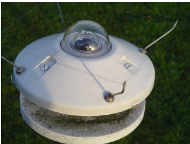
Figuur 4, met behulp van een "globale stralingsmeter" (Kipp CM 11, foto links) wordt de totale inkomende straling gemeten (in de Bilt, 06-26-0, op het dak van gebouw B, alwaar geen hinder is van omliggende gebouwen en bomen)
