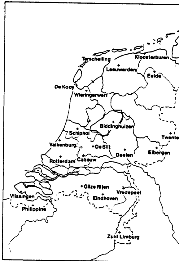
Figuur 5 Eerste ontwerp van het meetnet voor de globale straling en temperatuur. Het is de bedoeling om in landbouwgebieden nog enkele stations toe te voegen, namelijk in Nieuw Beerta, Marknesse, Hoogeveen, Hoorn en Wilhelminadorp.
