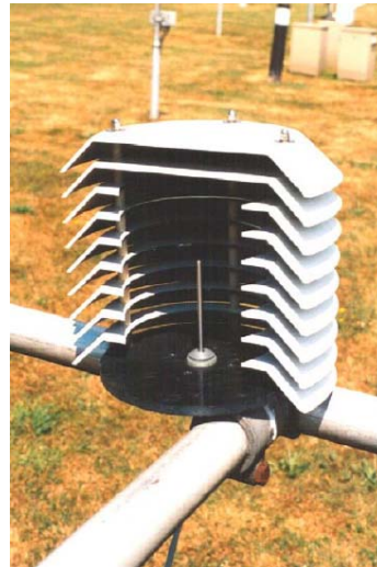
Figuur 9 Opengewerkte schotelhut type 04-02-030 met Pt-500 sensor.
