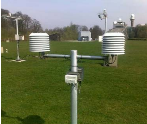
Figuur 8 De standaard opstelling op operationele stations. Links de vochtsensor, rechts de temperatuursensor. Op mistposten en op Noordzee platforms zijn alternatieve constructies in gebruik.
