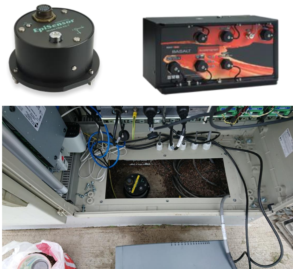
Figuur 2-4: Boven: versnellingsmeter met datalogger. Onder: versnellingsmeter op de bodem van een boorgatstation.
