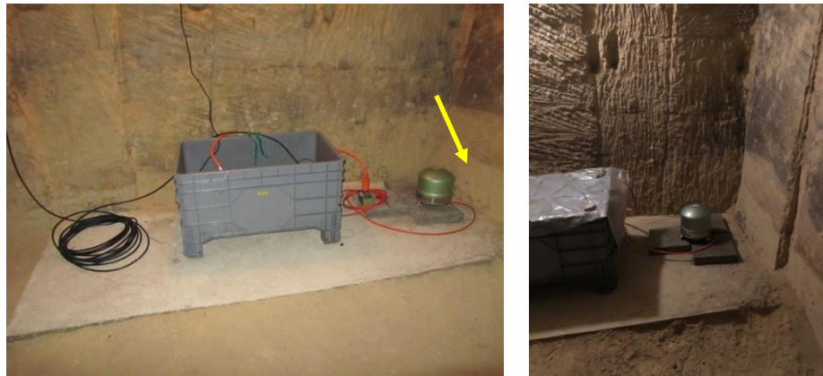
Figuur 2-5: Breedbandsensoren in de mergelgrotten bij Valkenburg.
