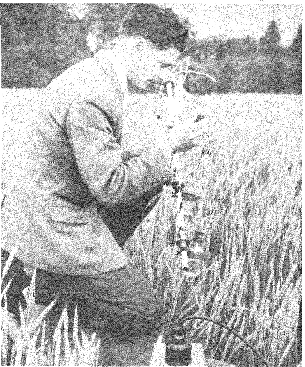
afb. 21: Een verfijnd stel instrumenten waarmee men in het veld de temperatuur, de vochtigheid, de straling, de wind, enz. kan meten, wordt tussen het gewas opgesteld. Gedurende de periode waarin gemeten wordt behoeft de waarnemer daar zelf niet meer tussen te lopen. Zo wordt voorkomen dat hij door zijn aanwezigheid de metingen zou verstoren.
