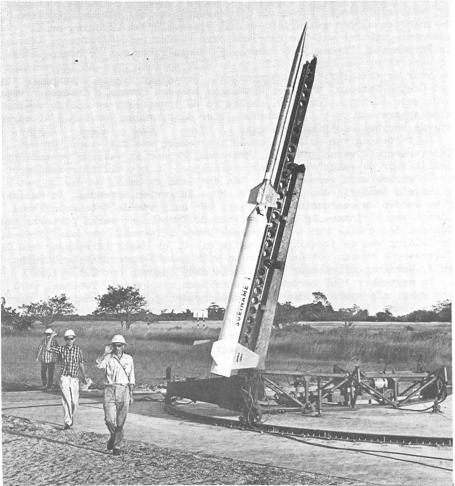
Een Nike-Apache raket staat klaar om te worden gelanceerd voor het onderzoek van de wind in de ionosfeer boven Suriname (foto R.V.D., Paramaribo).
