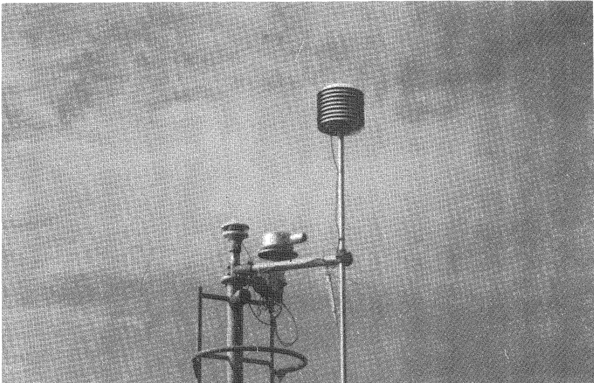
Foto 1: Meetmast met instrumenten voor het meten van temperatuur, globale- en langgolvlige straling.
