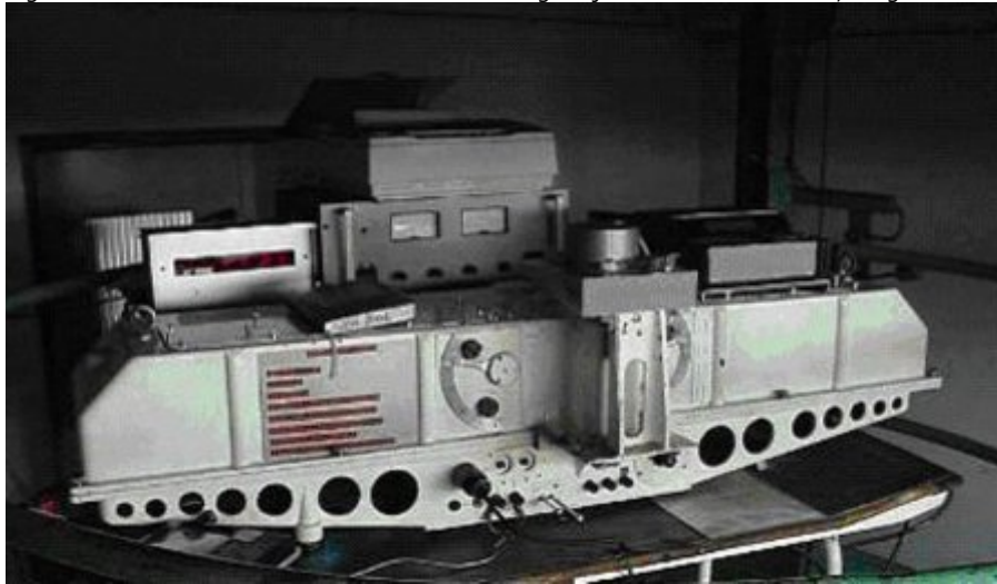
Figuur I1-2: Dobson instrument nummer 40 nog altijd werkzaam te Ukkel, België.
