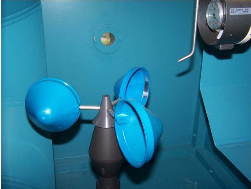
Figuur 3-2 Cup anemometer in de KNMI windtunnel en de persluchtstelling.
