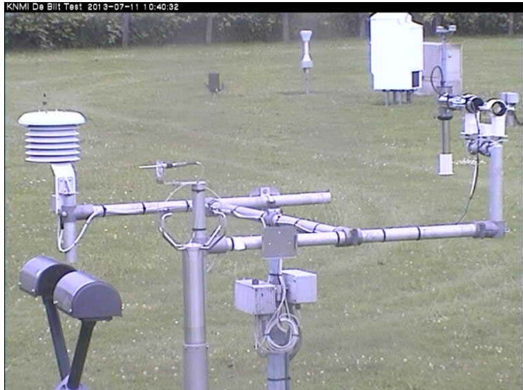
Figuur 20: Het H-frame + sonische anemometer
