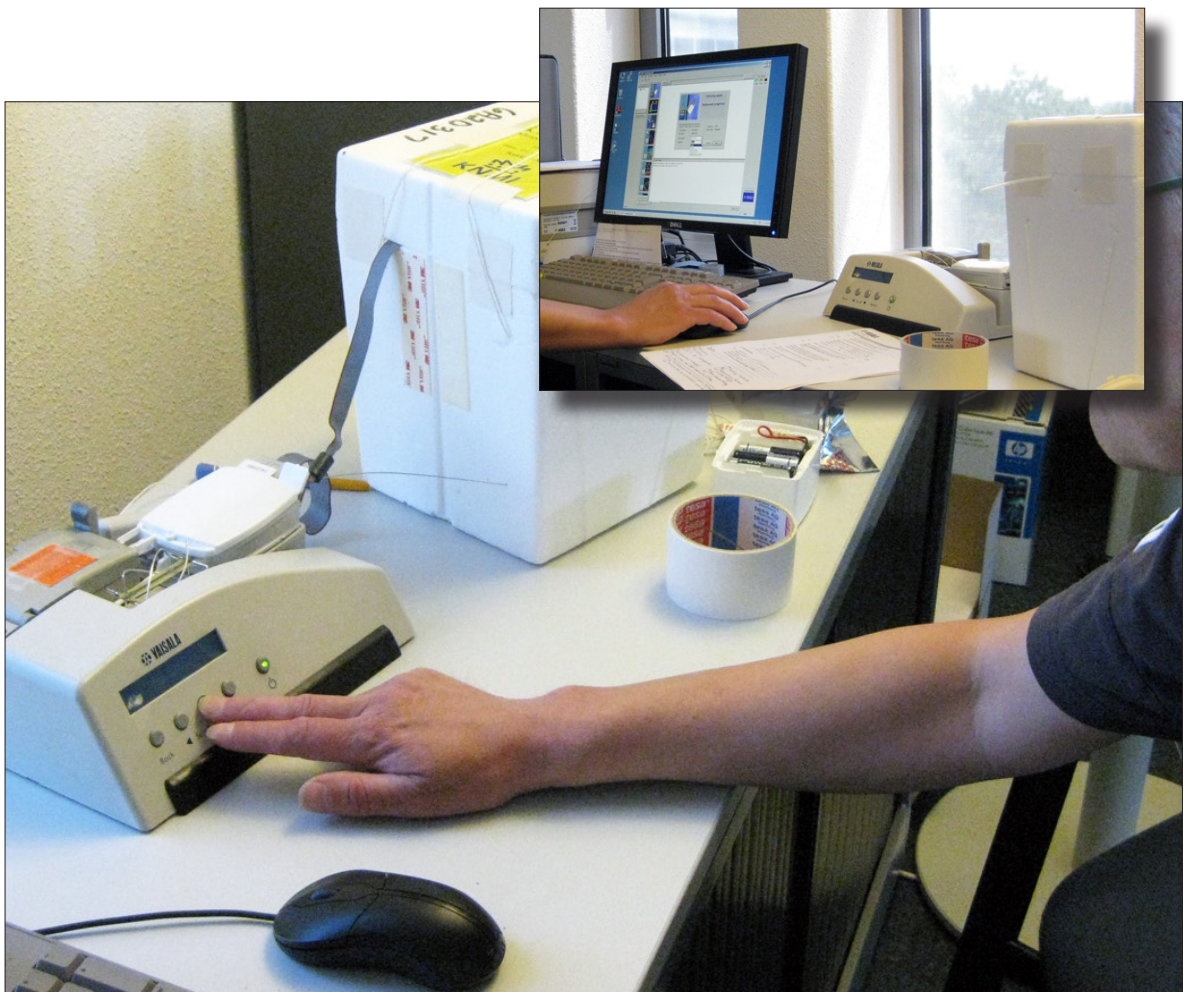
1. De radiosonde wordt in de weerkamer geijkt.
