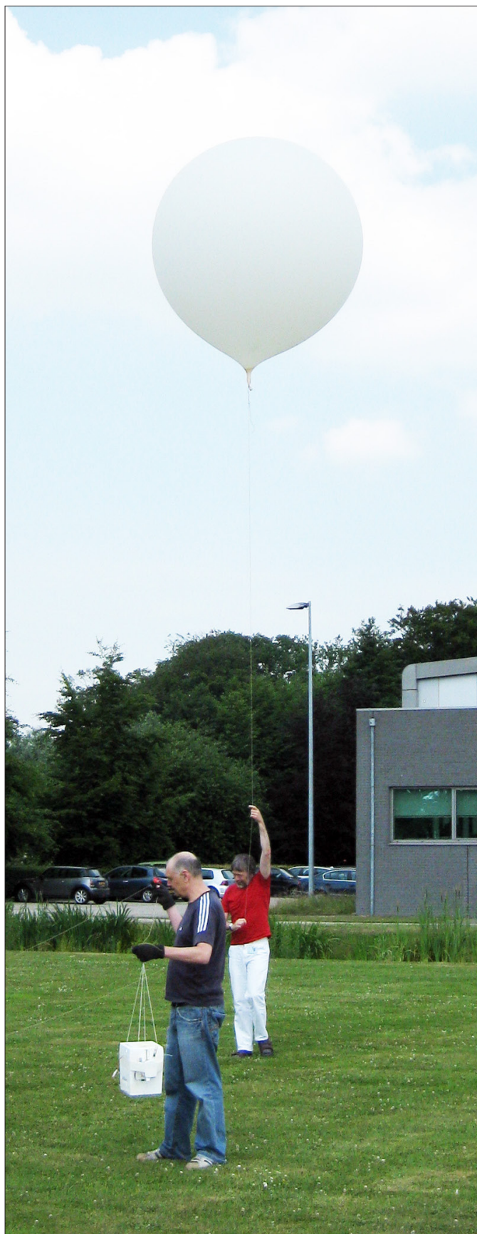
4. Het oplaten van de ballon met daaraan de radiosonde.
