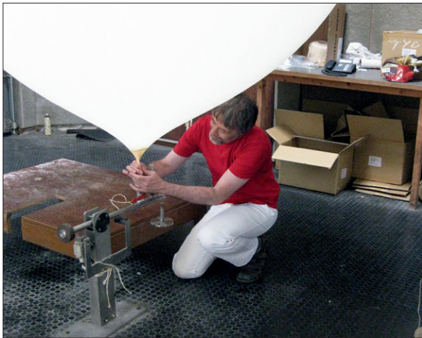
2. In de vulhut wordt de ballon gevuld met heliumgas.
