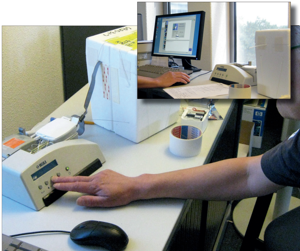
1. De radiosonde wordt in de werkamer geijkt.
