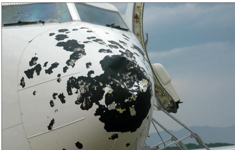
Zware schade aan een Boeing 737 van vliegmaatschappij EasyJet veroorzaakt door een fikse hagelbui. Schade veroorzaakt door grote hagelstenen komt regelmatig voor. Grote hagel met een diameter van 1 – 10 cm treedt vooral op bij supercell convectie.
