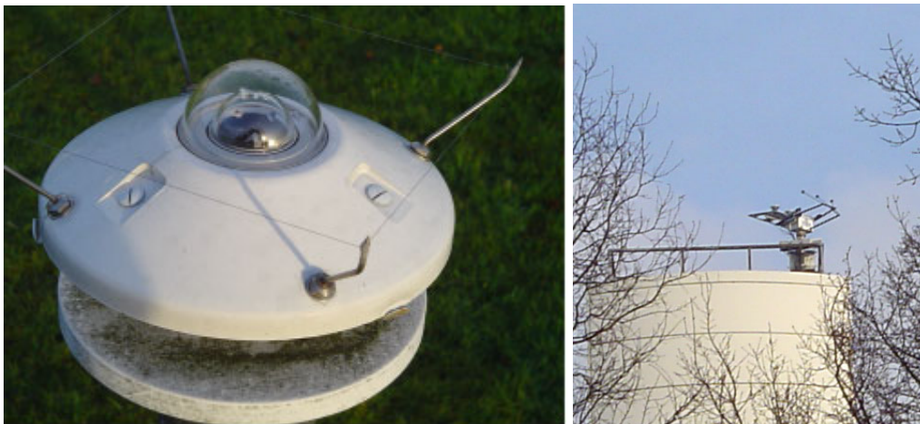
Figuur 4, met behulp van een "globale stralingsmeter" (Kipp CM 11, foto links) wordt de totale inkomende straling gemeten (in de Bilt, 06 260, op het dak van gebouw B, alwaar geen hinder is van omliggende gebouwen en bomen)
