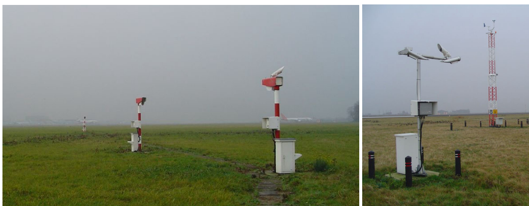
Figuur 1, een transmissometer (foto links) en een scatterometer (rechter foto) ter bepaling van zicht en RVR, zoals o.a. in gebruik op Schiphol. Op de rechter foto is ook een windmeter (met barometer) te zien, zoals in gebruik op luchthavens.
