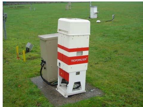
Figuur 6, typisch voorbeeld (links) van de tijdsafhankelijke output van een ceilometer (foto rechts), met als functie van de hoogte de mate van extinctie (in afnemende sterkte: rood, groen, geel, blauw, violet)
