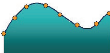
Figuur B5.1. Schematische voorstelling van het principe van RBF-interpolatie.
