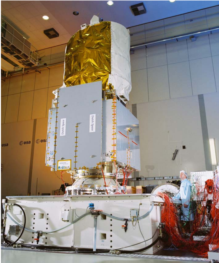
Figuur 5: Een prototype van de Aeolus satelliet op een trilplaat voor mechanische tests © ESA.
