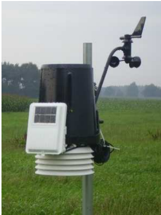
Figuur 3.1: De integrated sensor suite van een Davis Vantage Pro 2 weerstation. Bron: Remie van Bommel, http://www.wxhoogeloon.nl .
