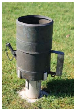
Neerslagmeter op een neerslagstation (links), automatisch weerstation van het KNMI (midden), en de neerslagradar in De Bilt (rechts). Foto's: KNMI.
