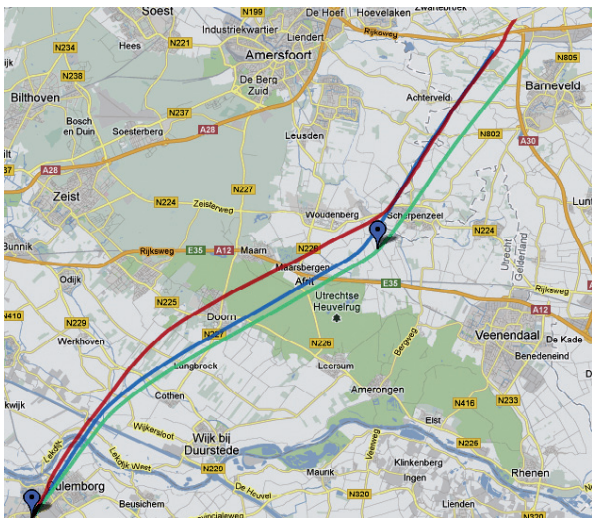
Figuur 4. Trajectoriën op 16 september 2012 volgens de ballon (rood), weermodel U11 (groen) en weermodel U11 (blauw) met ballonwinds geassimileerd in het eerste half uur van de vlucht aangegeven met het traject tussen de blauwe bolletjes.
