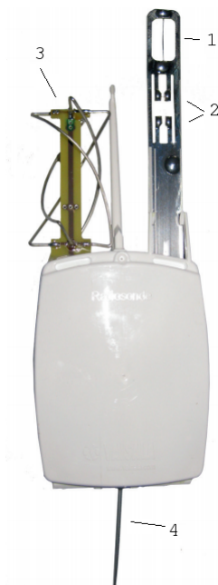
FIGUUR 3.1: Voorbeeld van een radiosonde met (1) thermometer, (2) vochtmeter, (3) GPS ontvanger en (4) radioantenne. De kleine drukmeter bevindt zich in de behuizing.
