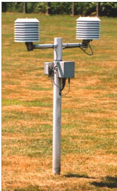
figuur 2a, opstelling met de schotelhut op een landstation (De Bilt)
