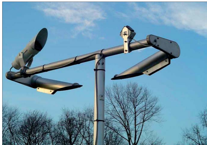
Figuur 4. Close-up opstelling scatterometer, inclusief achtergrondhelderheids-meter. Locatie: De Bilt (De neerslagdetector rechtsboven is ten behoeve van metingen van neerslagsoort)
