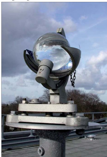
figuur: Campbell-Stokes autograaf. Niet meer voor operationeel gebruik na 1992. (foto John Kambeel)
