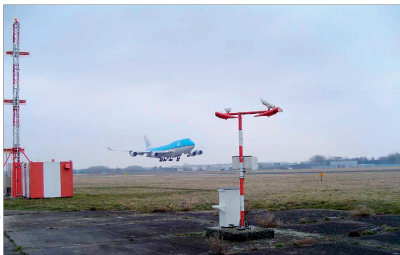
Figuur 3. Opstelling scatterometer, inclusief achtergrondhelderheids-meter. Locatie: Beek
