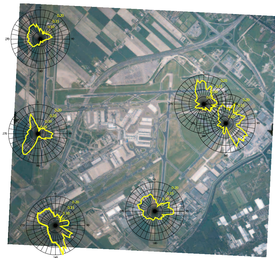
Figuur 7: Richtingsafhankelijkheid van de terreinruwheid voor de meetposities op de luchthaven Schiphol.
