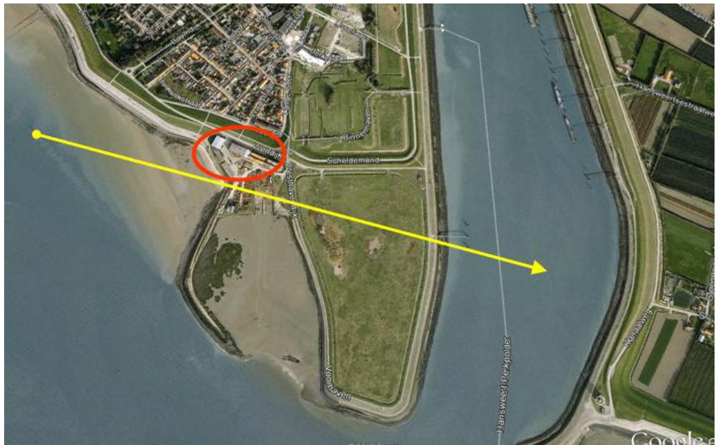
Figuur 11. De ligging van het meetpunt Hansweert (gele bol). De gele pijl geeft de windrichting aan tijdens de maximale windstoot (285°). Op circa 465 m afstand van het meetpunt bevindt zich bebouwing (rode cirkel).
