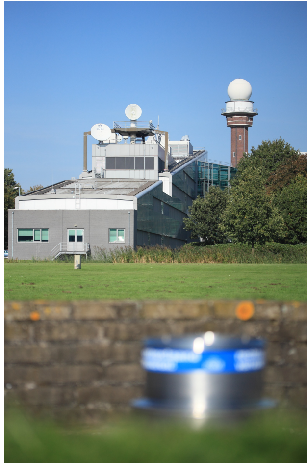
Figuur 2.4: Toren met de KNMI-radar in De Bilt met op de voorgrond een automatische regenmeter. Het beste van deze twee werelden wordt gecombineerd door radardata met regenmeterdata te corrigeren.
