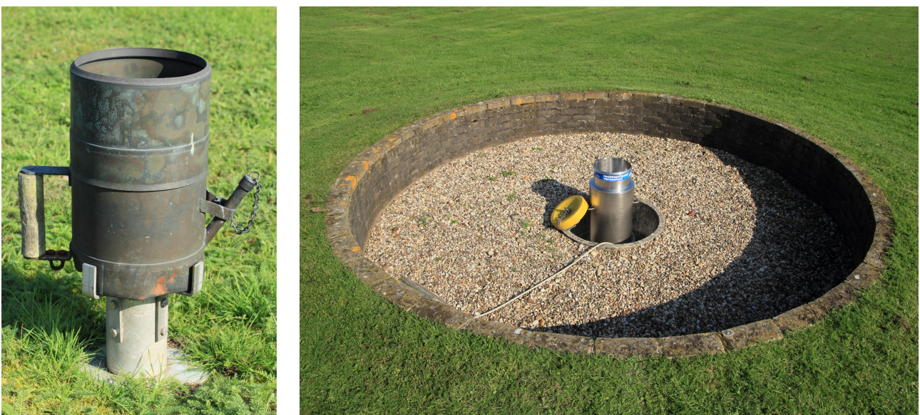
Figuur 2.3: De handregenmeter (links) en de opstelling van de automatische regenmeter met een aarden wal (Engelse opstelling), zoals gebruikt op de meeste locaties (rechts).
