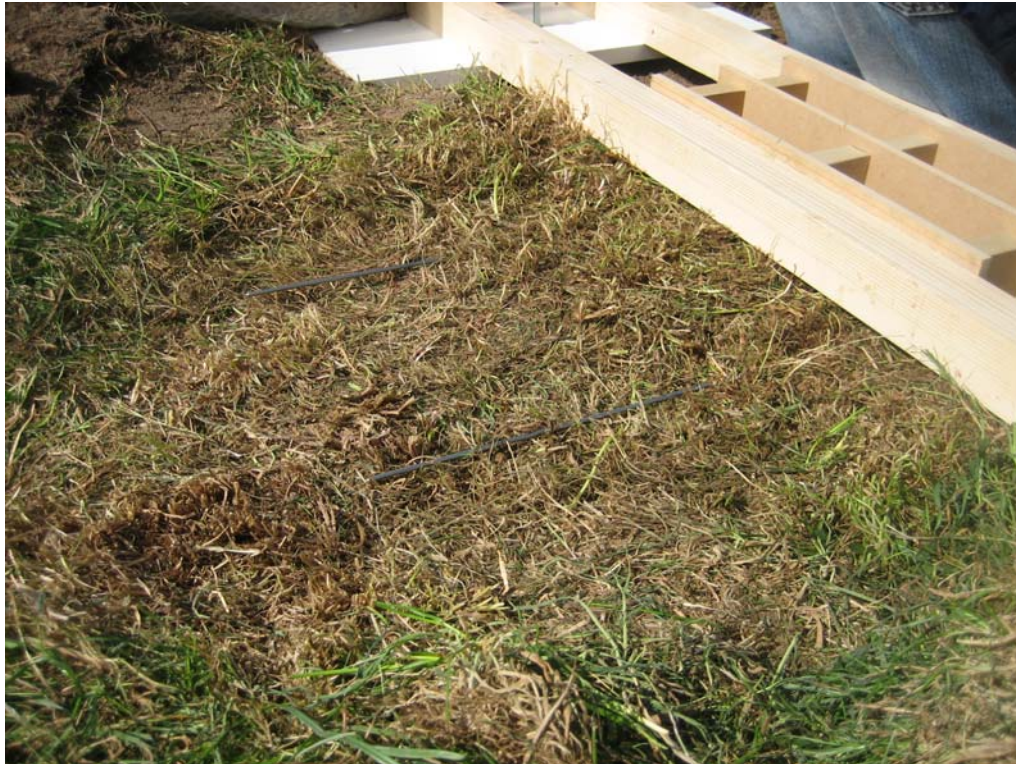
Figuur 6 Waar de topsensor boven het oppervlak uitsteekt wordt de aarde aangevuld.
