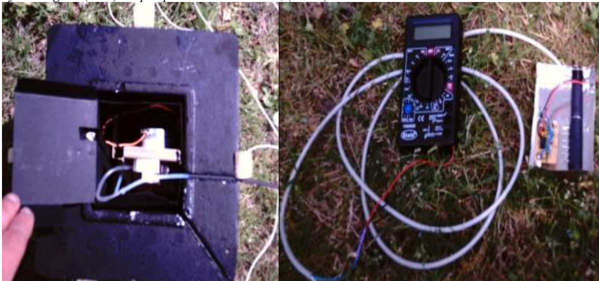
Afbeelding 32: (links) De pomp in het zwarte karton, (rechts) de detector
