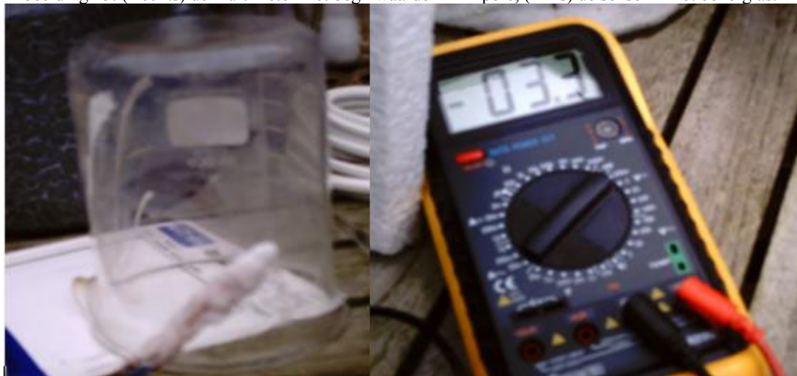
Afbeelding 15: (Rechts) de multimeter met beginwaarde in Ampère, (links) de sensor in het bekeerglas.
