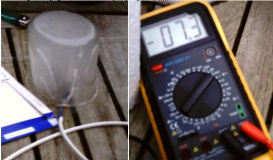
Afbeelding 17: Polystyreen sensor in rook (links), signaal multimeter (rechts)
