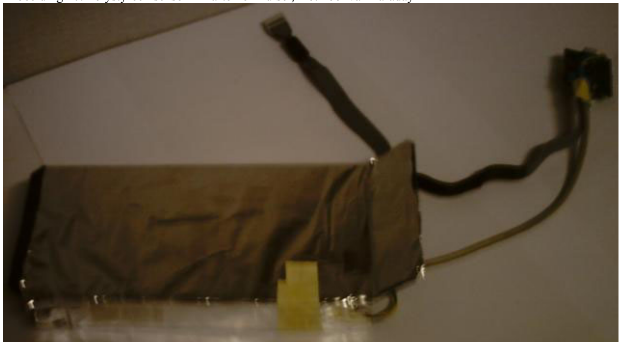
Afbeelding 20: Polystyreen sensor in karton omhulsel, met kooi van Faraday
