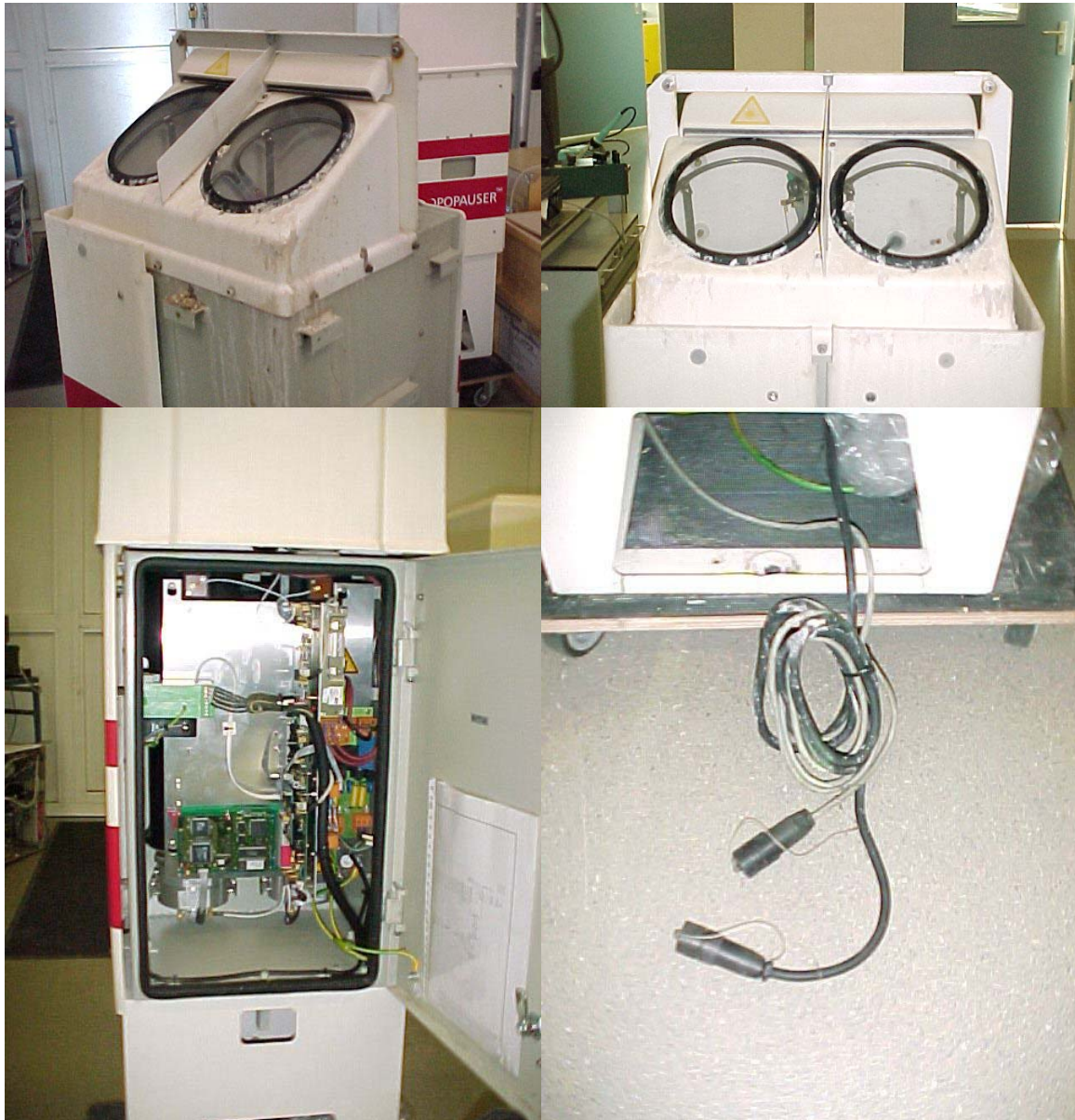
Figuur 8. Enkele foto's van de vervuilde LD40 na afloop van de 8 maanden duurtest op de Meetpost Noordwijk met van links naar rechts en van boven naar beneden: de behuizing van de LD40; het venster; intern en de kabels.
