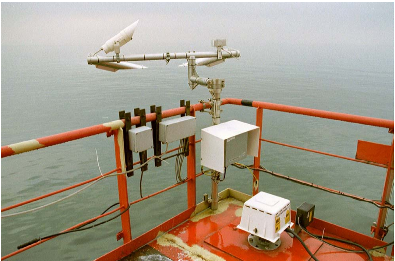
Figuur 1. Schema van de Meetpost Noordwijk met aanduiding van de locaties van de LD40 en FD12P tijdens de duurtest en foto van de FD12P opstelling (Foto OCN B.V.).
