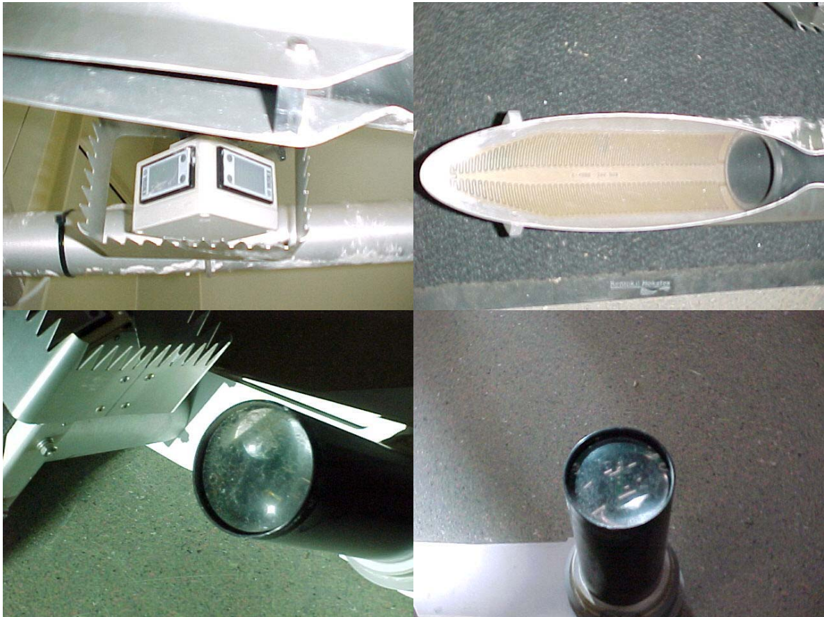
Figuur 16. Enkele foto's van de vervuilde FD12P na afloop van de 8 maanden duurtest op de Meetpost Noordwijk. Van links naar rechts en van boven naar beneden zijn te zien de DRD, de kop van de zender, de lens van de zender en van de ontvanger.
