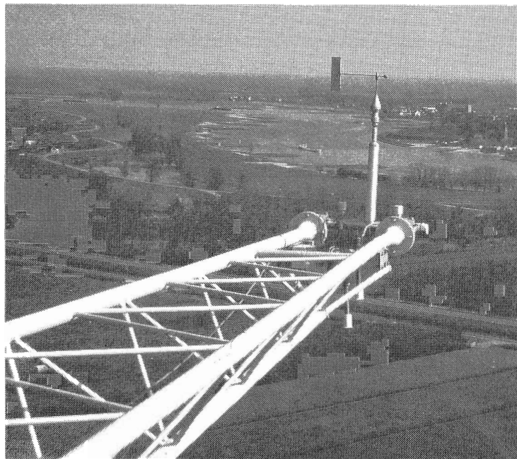
Figuur 6.1.5 Zuidoostuithouder Aan de onderzijde zijn de droge- en nattebolsensor van het temperatuurmeetsysteem te zien.
