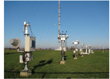
Figuur 2. Foto van het BSRN station in Cabauw (december 2008) met op de achtergrond de 213 m hoge meetmast. Centraal staat de zonnenvolger met beschaduwde pyranometers (voor het meten van diffuse straling), een pyrgeometer (neerwaartse langgolvlige straling) en pyrheliometers (directe straling). Verder staan er op de site instrumenten voor het meten van aerosol optische dikte, bedekkingsgraad en wolken-temperatuur, zonneshijnduur en UV straling. Voor meer informatie en quicklooks: [3].
