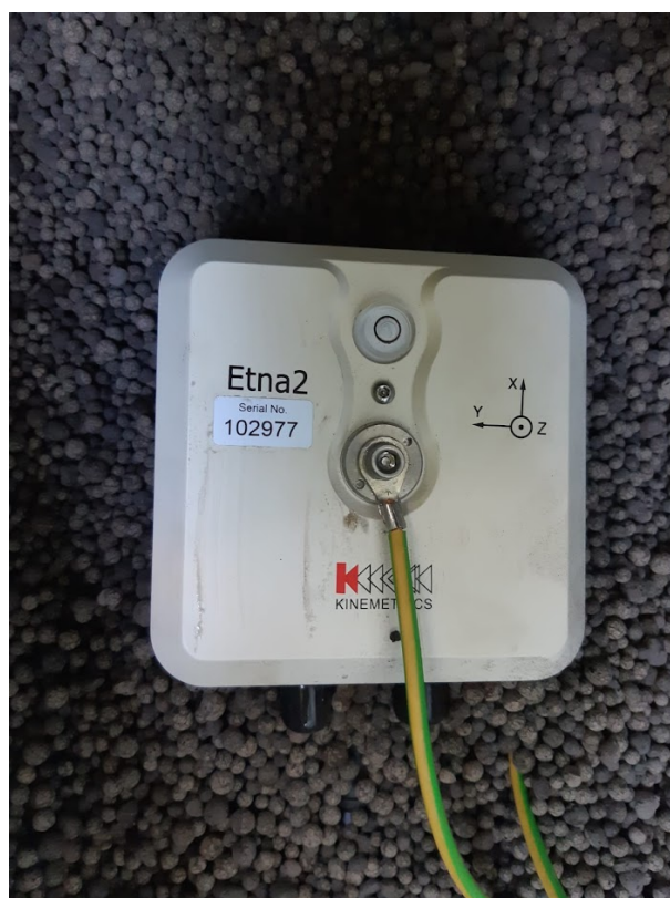
Figuur 3: Hydrokorrels rond een versnellingsmeter. Voor een goede bescherming tegen ongedierte, bijvoorbeeld mieren, moet de hele sensor bedekt zijn met hydrokorrels.
