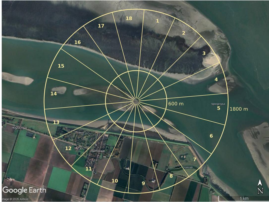
Figure F.25: Directional sectors around the wind mast at Hoofdplaat (311).
