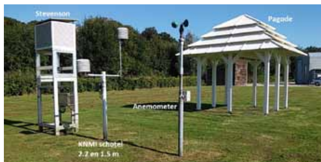
Figuur 2. Opstelling met gereconstrueerde pagode op het KNMI-testveld. Foto genomen in noordelijke richting. In dit artikel vergelijken we temperatuurmetingen (op 2.2 m boven maaiveld) in de Stevensonhut en in de pagode.
